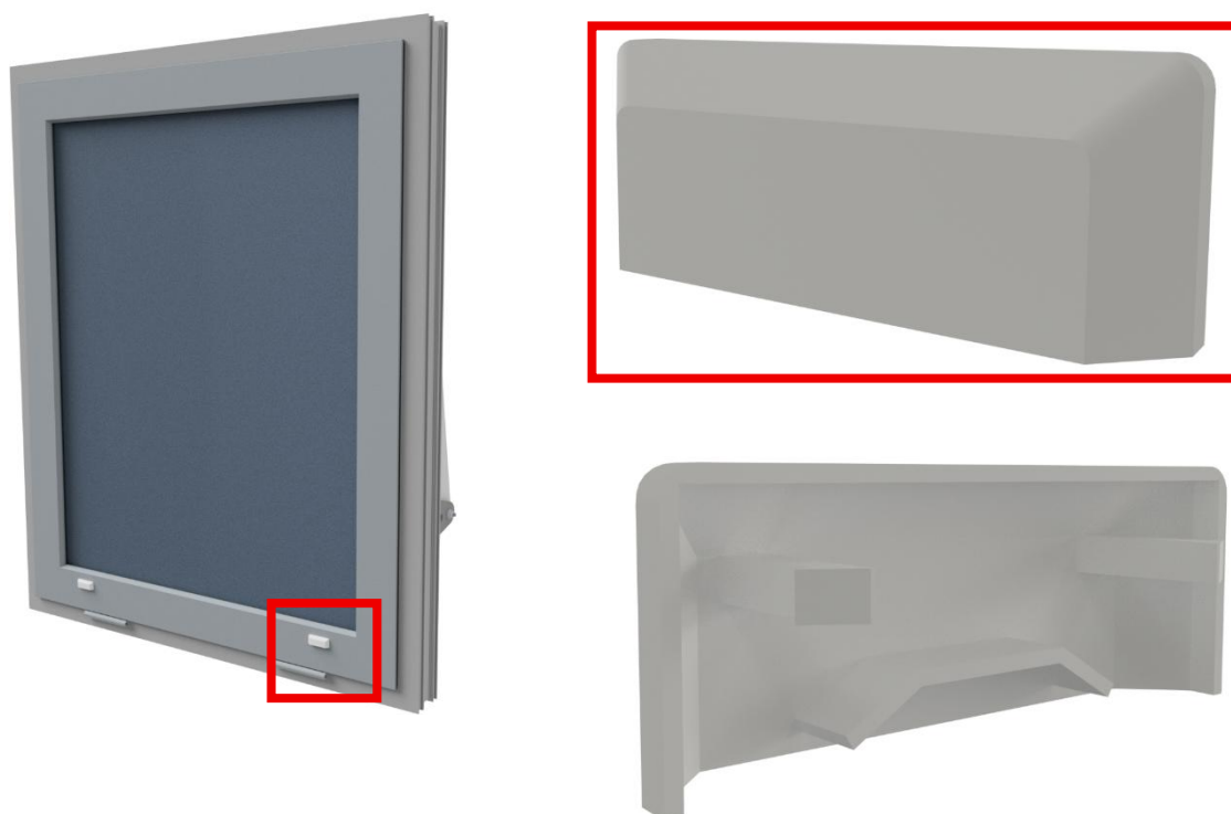
Rys. 16 Zamontowane zaślepki wraz z ich orientacją i widokiem przód/tył – okno otwierane na zewnątrz.
